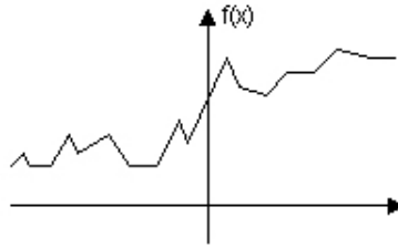
Abbildung 10: Eine reale Kante ist meist eine Kombination idealer Kantenprofile, überlagert mit Rauschen
