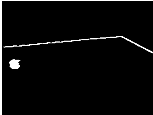
Abbildung 17: Das Bild von Abbildung 16 auf der vorherigen Seite nach Ausführung einer Differenzoperation der Farbkanäle ROT – GRÜN und anschließender Binarisierung
