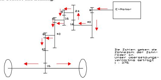
Dieses Schaubild zeigt den Kraftfluss vom Motor zur angetriebenen Achse.
